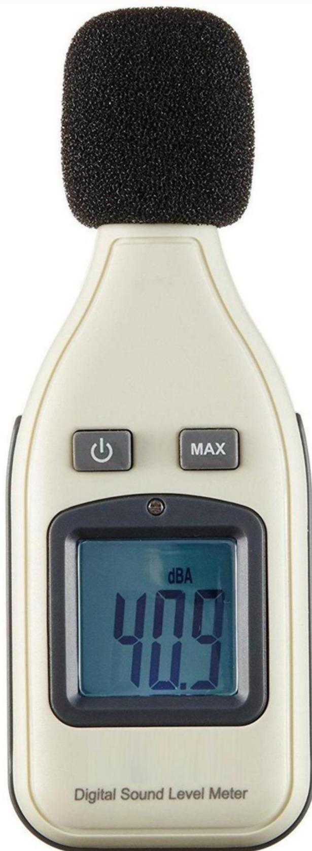
Cet appareil vous permet de mesurer rapidement et facilement le niveau sonore avec une évaluation de fréquence. Idéal pour mesurer facilement les bruits ambiants et les autres sources de bruit.
